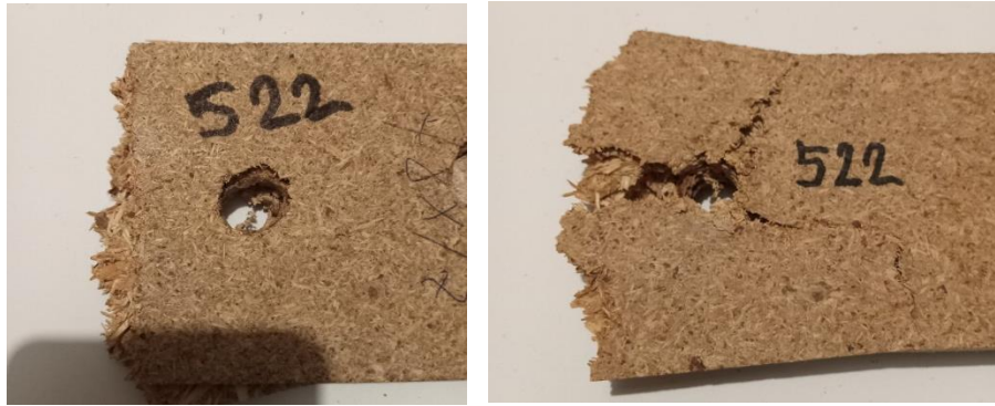
Рис. 21. Результати випробувань ДСП 50x50x17 мм, на яких видно характерні особливості зони руйнування.
