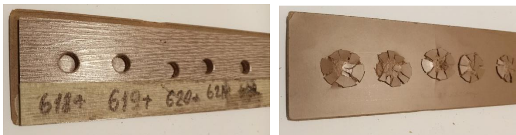
Рис. 22. Результати випробувань ХДФ 50x50x8 мм, на яких видно характерні особливості зони руйнування.
