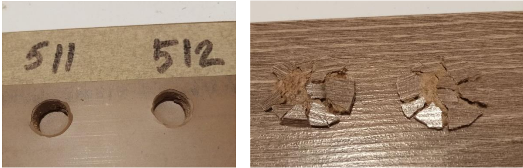
Рис. 24. Результати випробувань ХДФ 50х50х8 мм, на яких видно характерні особливості зони руйнування.
