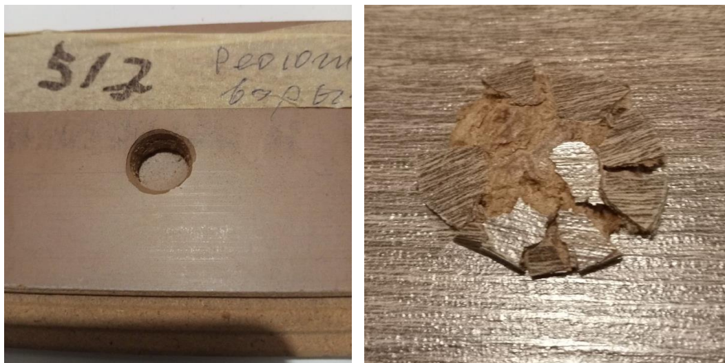
Рис. 23. Результати випробувань ХДФ 50x50x8 мм, на яких видно характерні особливості зони руйнування.
