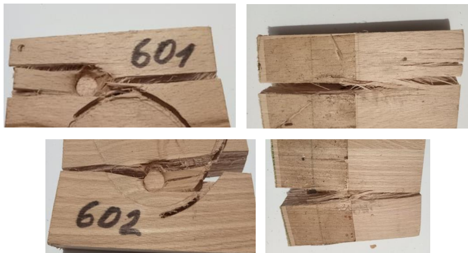
Рис. 20. Результати випробувань бука 108х80х21 мм, на яких видно характерні особливості зони руйнування.
