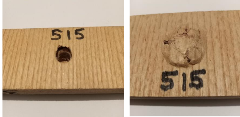
Рис. 15. Результати випробувань фанери 50x50x20 мм, на яких видно характерні особливості зони руйнування.
