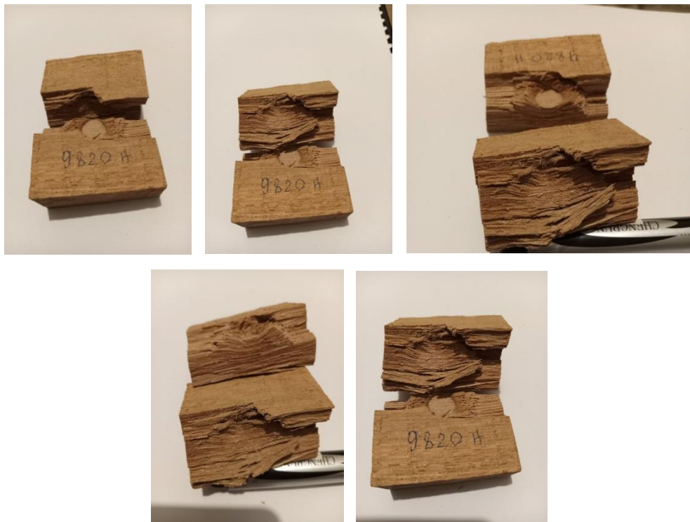
Рис. 16. Результати випробувань дуба 65x57x30 мм, на яких видно характерні особливості зони руйнування.
