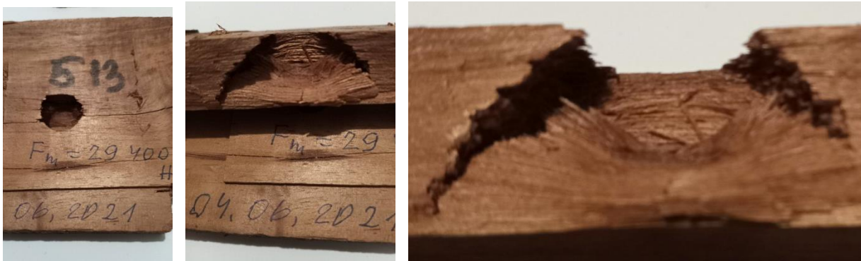
Рис. 13. Результати випробувань червоного дерева 126x84x18 мм, на яких видно характерні особливості зони руйнування.
