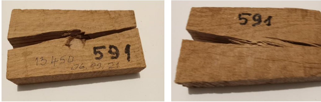
Рис. 18. Результати випробувань дуба 115х57х25 мм, на яких видно характерні особливості зони руйнування.
