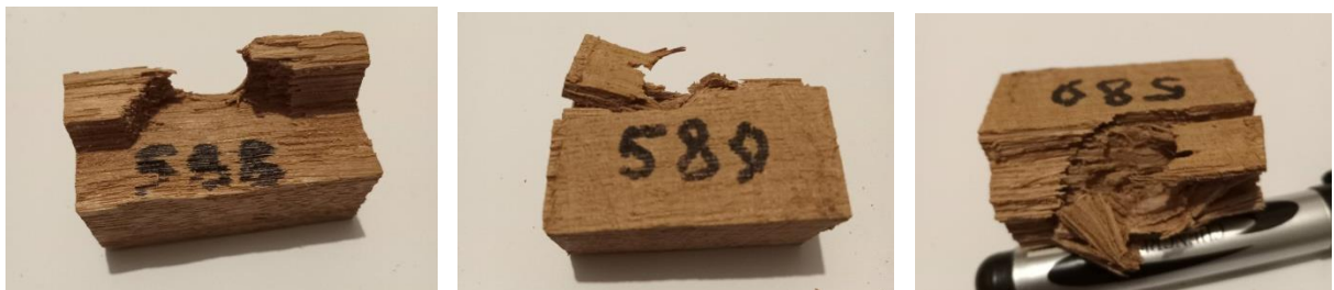
Рис. 17. Результати випробувань дуба 65x57x30 мм, на яких видно характерні особливості зони руйнування.
