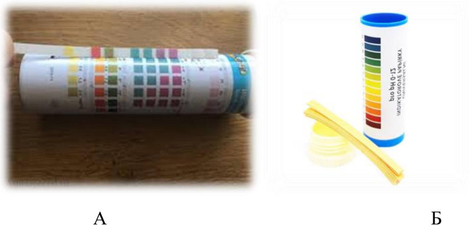
Рис. 2.1.2. Тест-смужки для вимірювання жорсткості (А) та рН (Б) водного середовища
