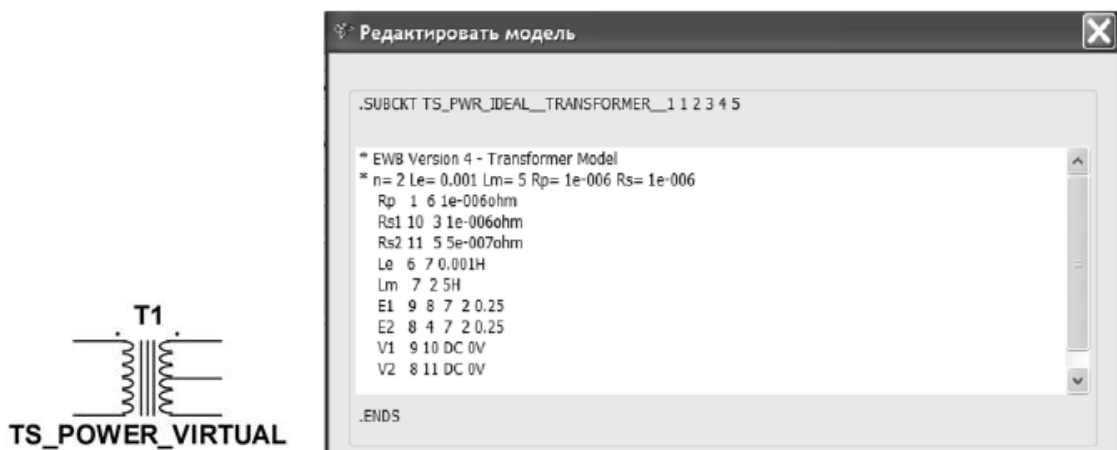
Рисунок 2.5. Зображення та опис макромоделі віртуального силового трансформатора TS_POWER_VIRTUAL
