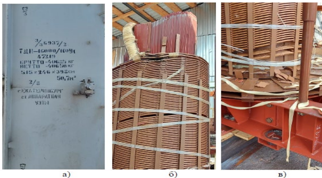
Рисунок 4 – ТДН-16000/100У1 (а – параметри трансформатора; б – місце плавлення обмотки; в – зміщення обмотки)
