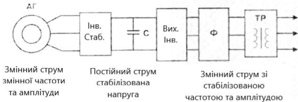
Рисунок 2.1 Схема електрогенераторного агрегату на базі асинхронного генератора з короткозамкненим ротором. АГ - асинхронний генератор з короткозамкненим ротором; Інв.Стаб. - інвертор-стабілізатор; С - блок конденсаторів; Вих.Інв. - вихідний інвертор; Ф - вихідний фільтр; ТР - силовий трансформатор.
