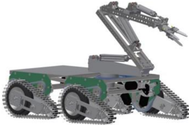
Рисунок.1.2 Твердотільна модель наземного роботизованого комплексу у вигляді мобільної транспортної платформи оснащеної комплектним маніпулятором важільного типу
