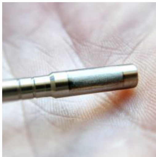
Рис. 1.14. Знос голки розпилювача
