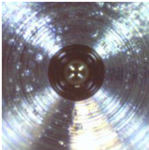
Рис. 1.11. Відновлення сідла мультиплікатора
