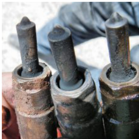
Рис. 1.9. Обгорілі гайки розпилювача
