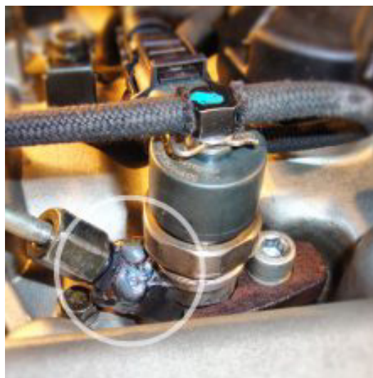
Рис. 17. Приварений штуцер до корпусу форсунки
