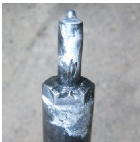
Рис. 1.15. Прогоріла гайка форсунки
