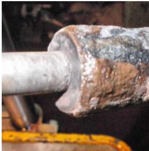
Рис. 16. Іржава форсунка CR
