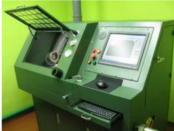
Рис. 2.2. Стенд для дослідження турбокомпресорів ІТК-3
