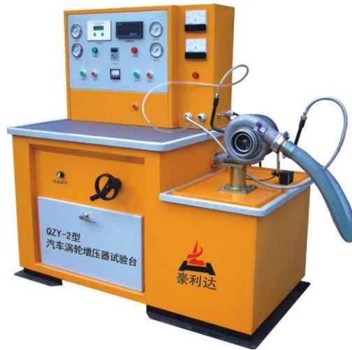
Рис. 2.1. Стенд для дослідження турбокомпресорів QY-2
