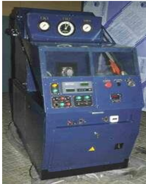
Рис. 2.3. Стенд для дослідження турбокомпресорів СТТ-06
