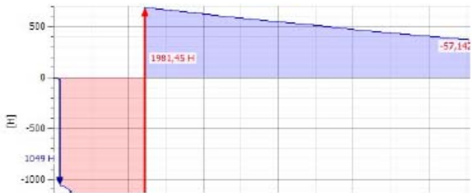
Рис. 2.10. Сила зсуву по площині YZ
