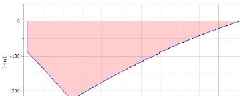
Рис. 2.12. Згинальний момент на площині YZ
