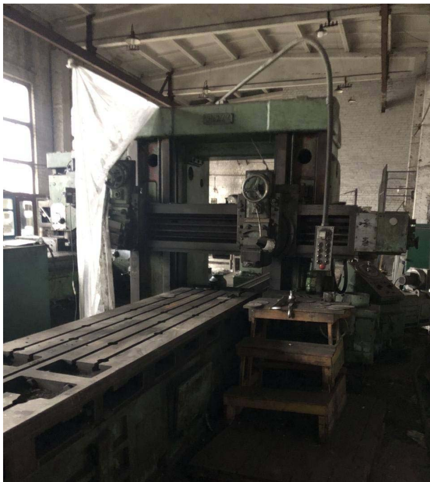
Рис.1.1. Поздовжньо-стругальний верстат моделі 7A256
