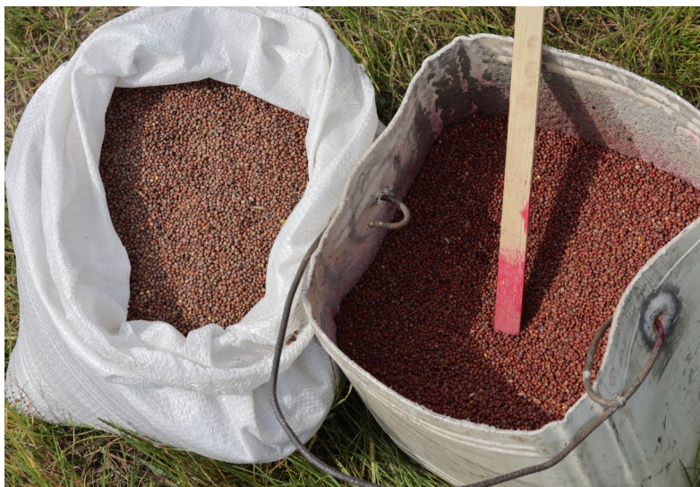
Рис. 2. Фарбоване насіння озимого ріпаку для оцінки рівномірності розподілу після посіву агродроном.
