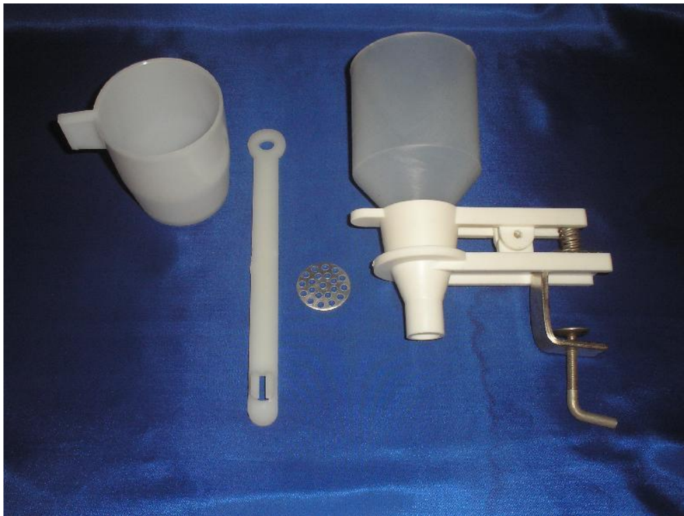
Рис. 4. Прилад «Рекорд» для визначення групи чистоти молока
