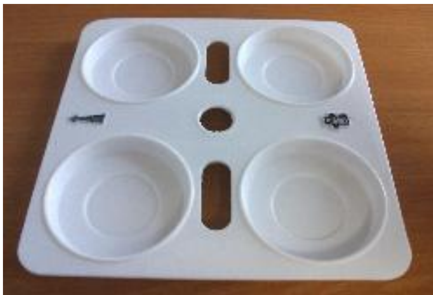
Рис. 3. Молочно-контрольна пластинка ПМК-1 для визначення кількості соматичних клітин у молоці
