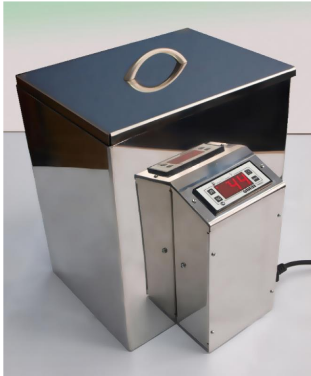
Рис. 5. Редуктазник «ЛТР» для проведення редуктазної проби молока з резузарином
