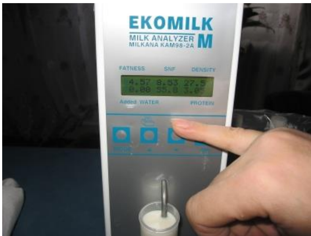
Рис. 2. Ультразвуковий аналізатор ЕКОМІЛК–М для визначення показників якості молока
