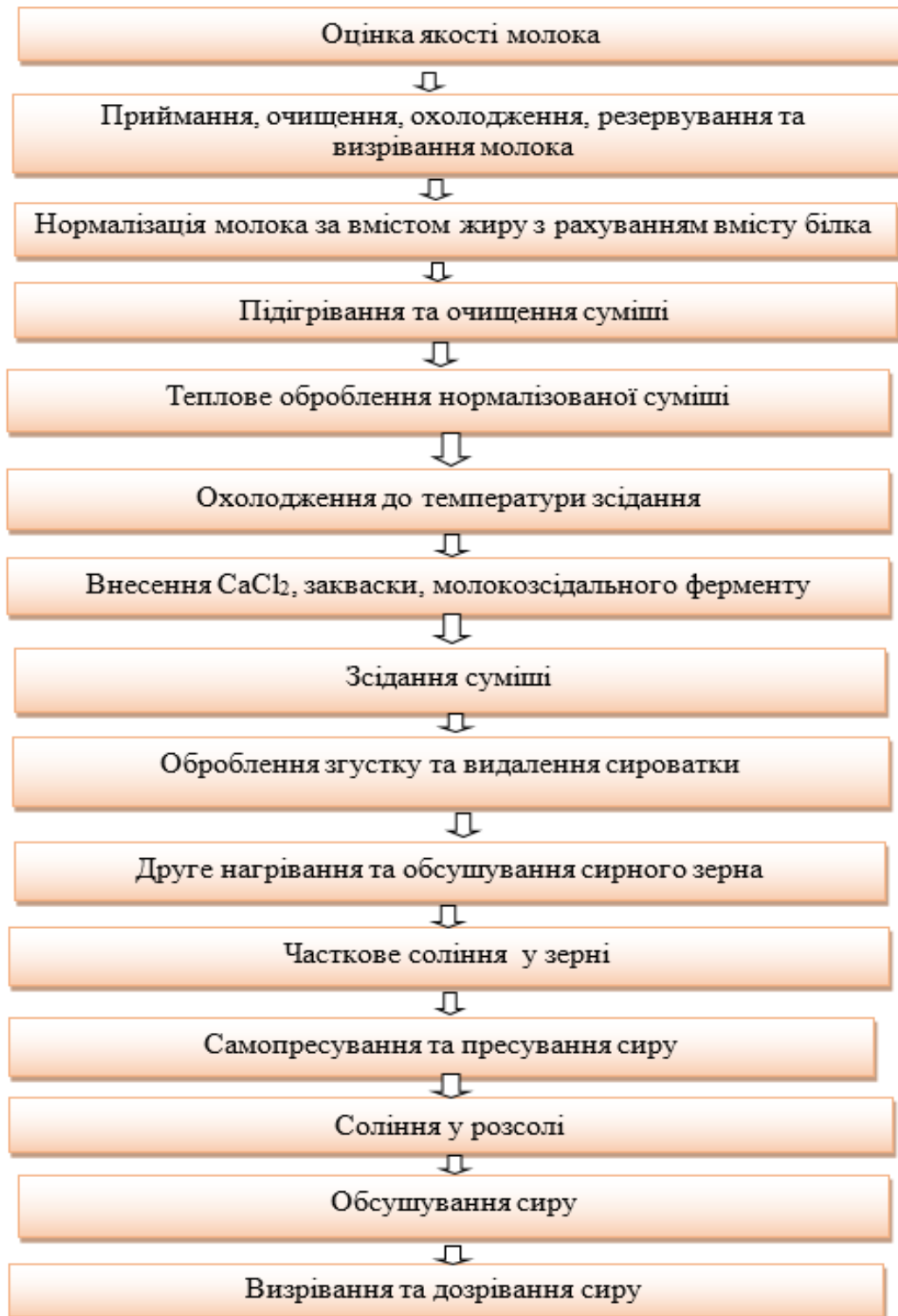
Рис. 3.20. Загальна технологічна схема виробництва сичужного сиру
