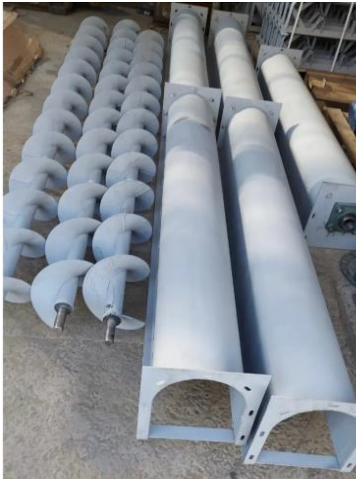
Рис. 2.2. Загальний вигляд вузлів шнекового транспортера перед монтажом.
