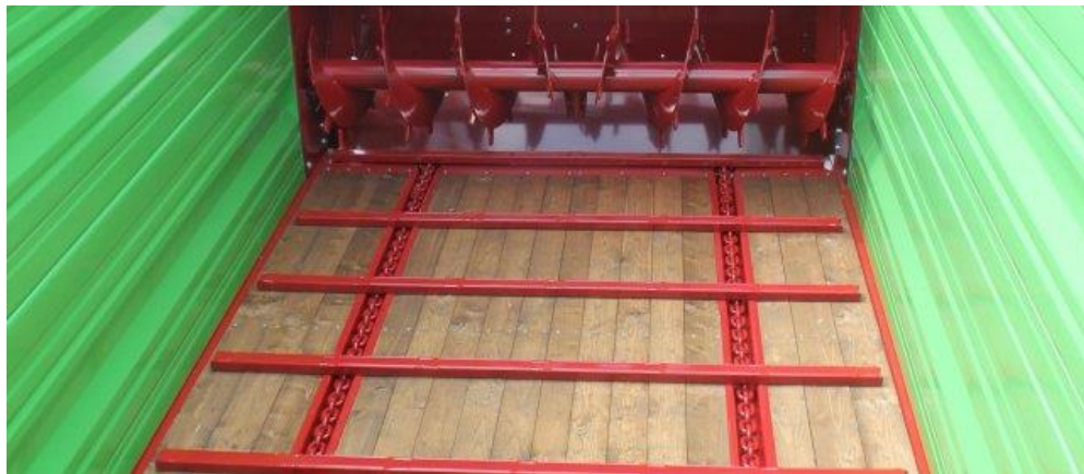
Рис. 1.2. Роздавач кормів Strautmann FVW 120 (Німеччина): а – загальний вигляд; б – блок бітерний та подаючий транспортер [11]
