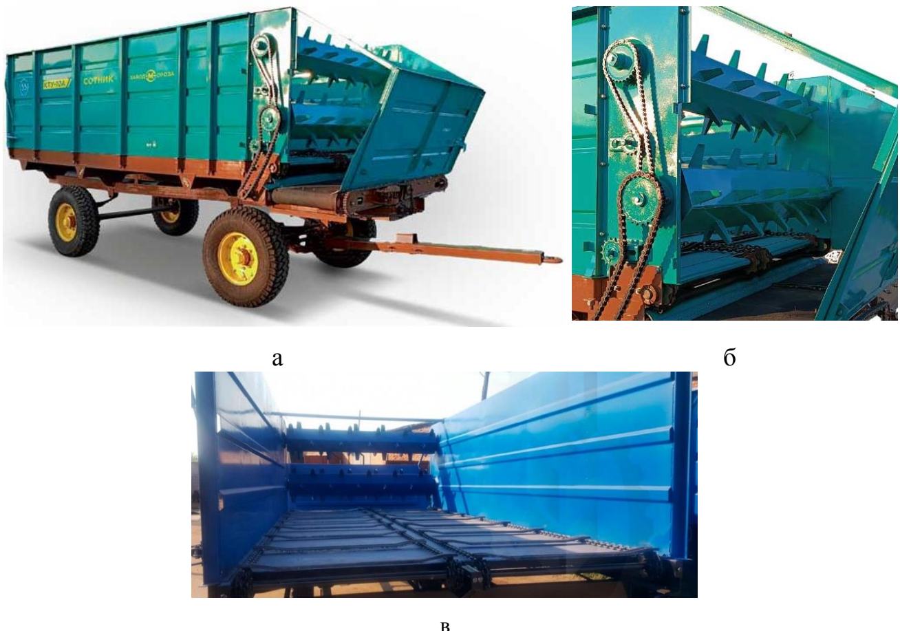
Рис. 1.1. Роздавач кормів КТУ-10А виробництва ТОВ «Завод Мороза» (Україна, Запорізька обл., Оріхівський р-н, с. Преображенка): а – загальний вигляд; б – блок бітерний; в – поздовжній подаючий механізм [9]
