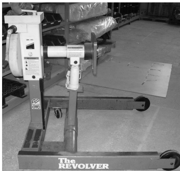
Рис. 3.1 Схема стенду для розбирання збірки двигунів: 1 – платформа; 2 – стійка; 3 – плита; 4 – редуктор; 5 – рукоятка [7]
