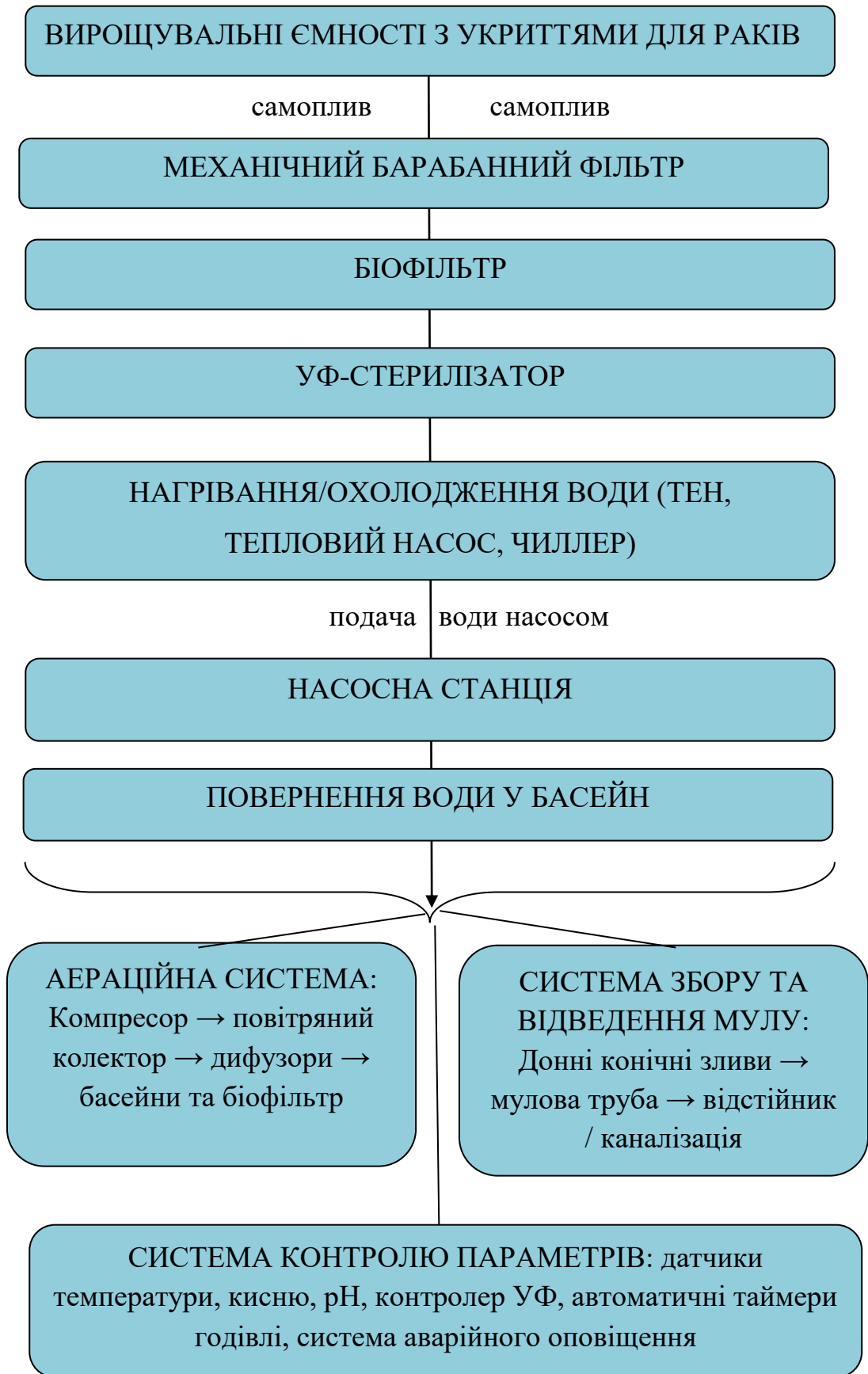
Рис. 5. Блок-схема УЗВ-модуля для вирощування раків
