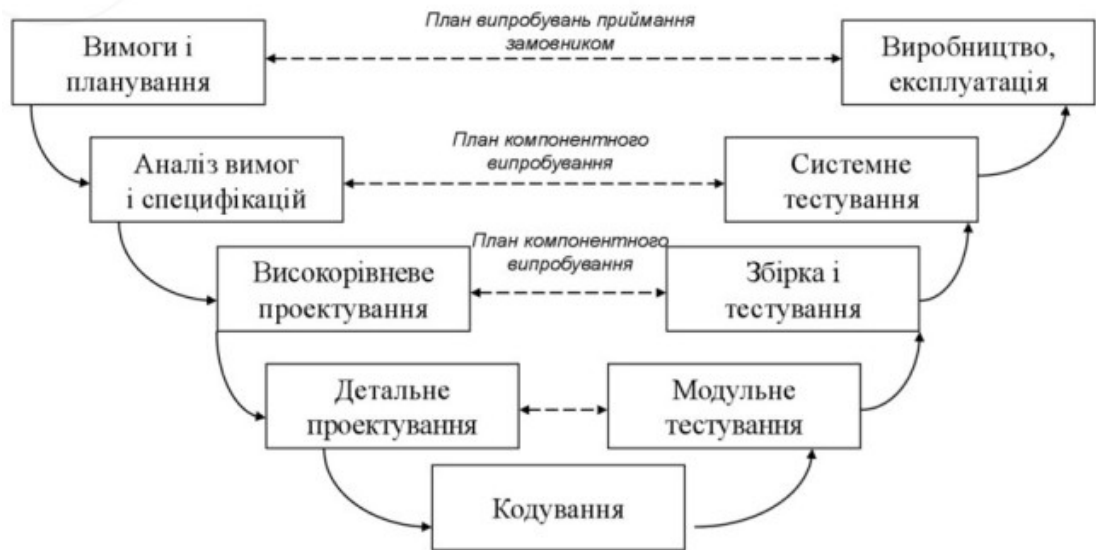
Рис. А.3 - Водоспадна модель розробки програмного забезпечення
