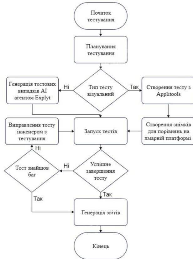
Рис. Б.1 - Блок-схема алгоритму створення автоматизованих тестів на основі AI
