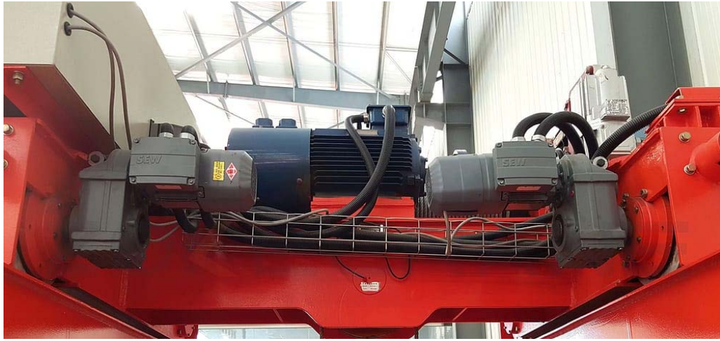
Рис.1.4. Механізм переміщення крана [2]
