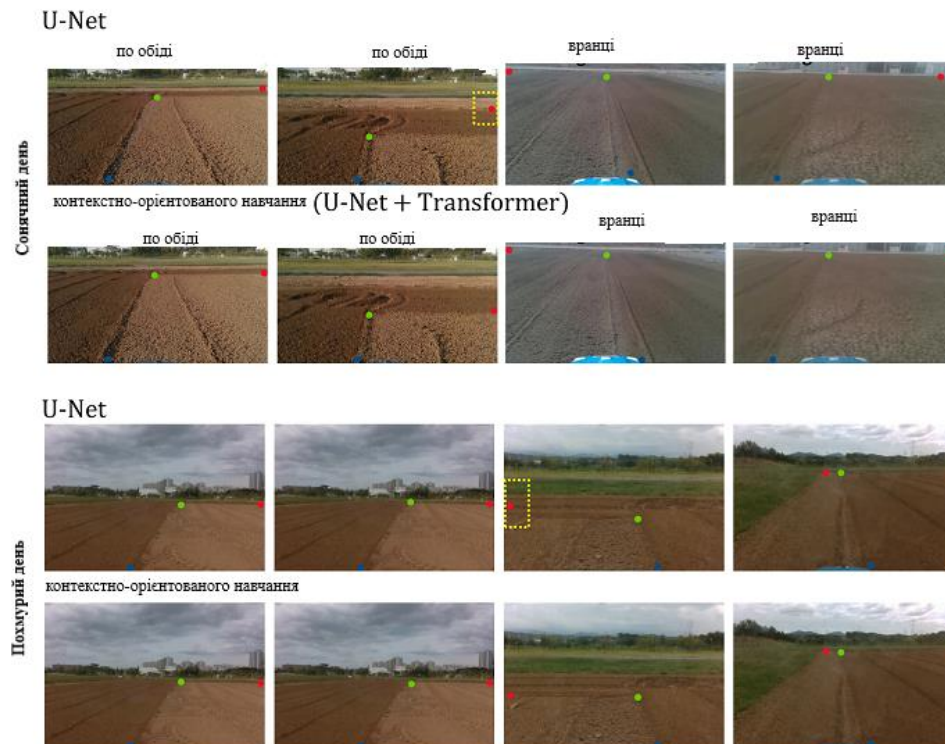
Рис. 3.2. Візуальне порівняння виявлення меж обробітку ґрунту за різних умов освітлення з використанням базової регресії теплових карт (U-Net) та контекстно-орієнтованого навчання
