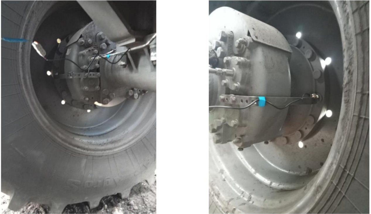
Рис. 2.11. Установлення індукційних датчиків на колесах
