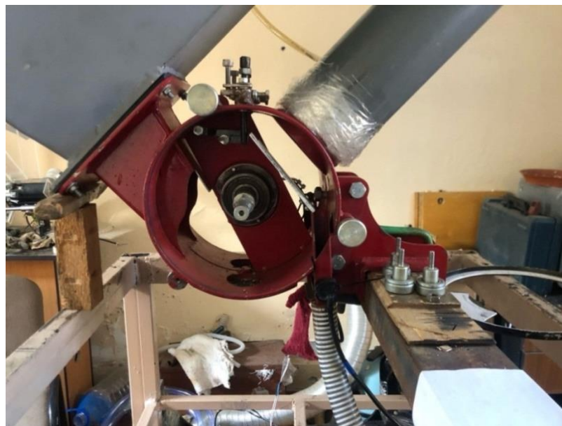
Рис. 2.7. Висівний апарат з нагнітальним повітряним потоком
