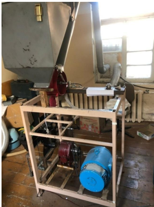
Рис. 2.4. Стенд для дослідження висівного апарата з нагнітальним повітряним потоком
