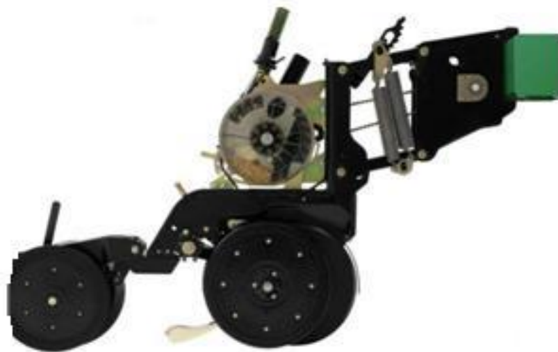
Рис. 1.2. Посівна секція сівалки YP-825A [21].
