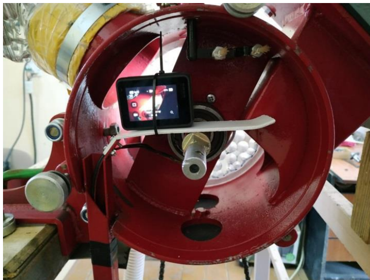
Рис. 2.8. Розташування високошвидкісної мінівідеокамери в апараті.
