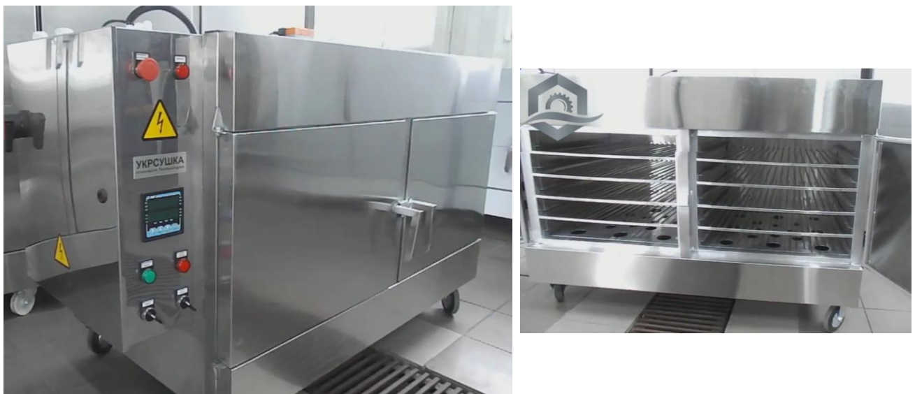
Рис. 1.3. Сушарка з використанням інфрачервоного випромінювання [7, 9]
