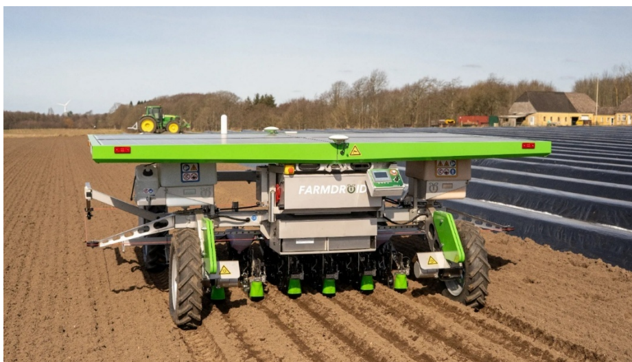
Рис. 1.1. Польовий робот FarmDroid FD20 [2].
