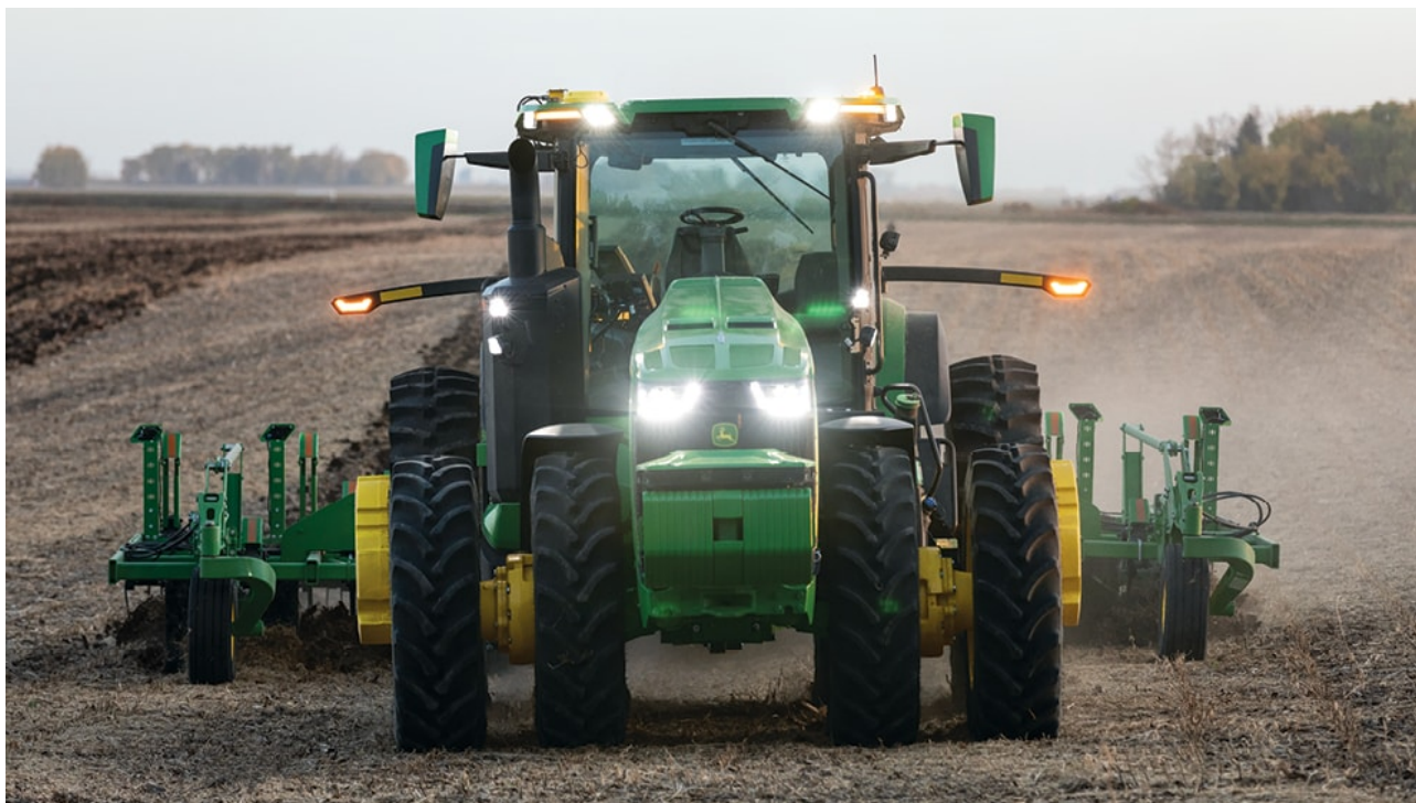
Рис. 1.8. Комерційний автономний трактор на базі моделі 8R [2].
