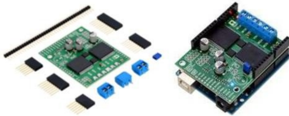
Рис. 2.6. Плата драйвера двигуна Pololu dual vnh5019
