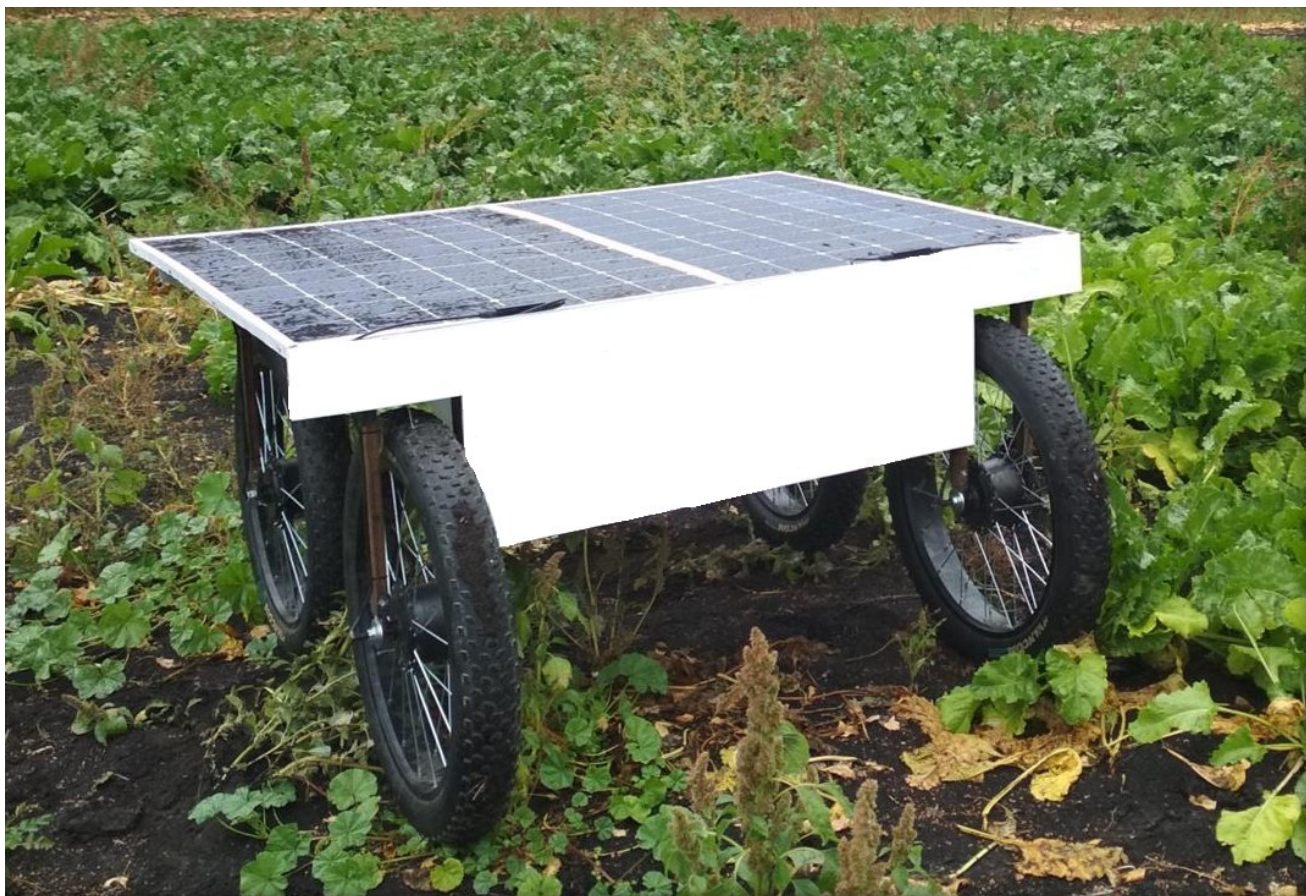
Рис. 2.5. Розроблений БПА з пристроєм електрозарядки крапель вносимої рідини
