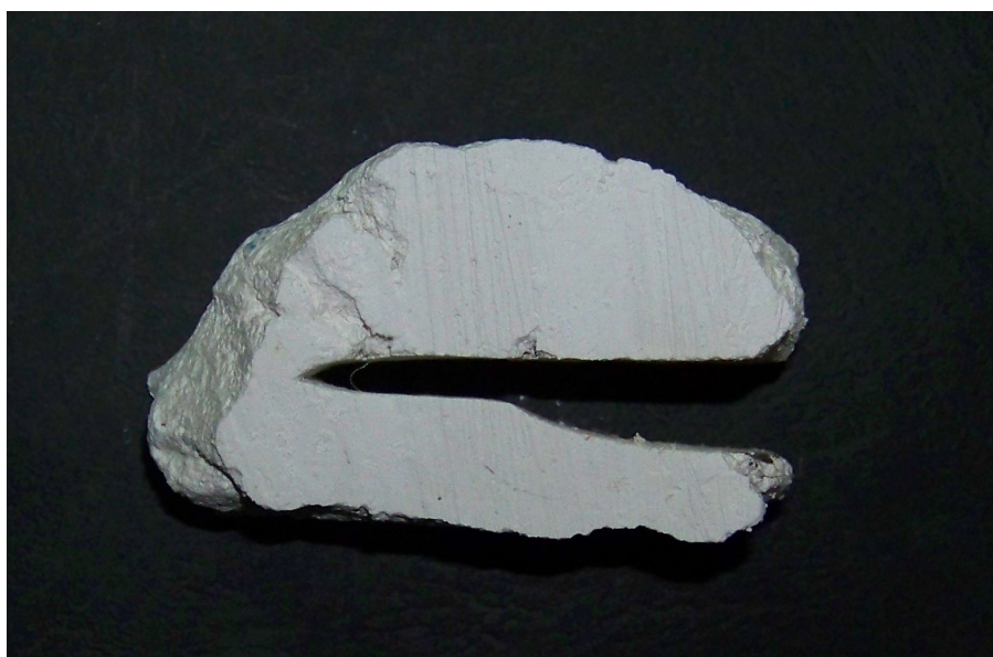
Рис. 3.5. Загальний вигляд поперечного перерізу відбитка ріжучої кромки дискового робочого органу.
