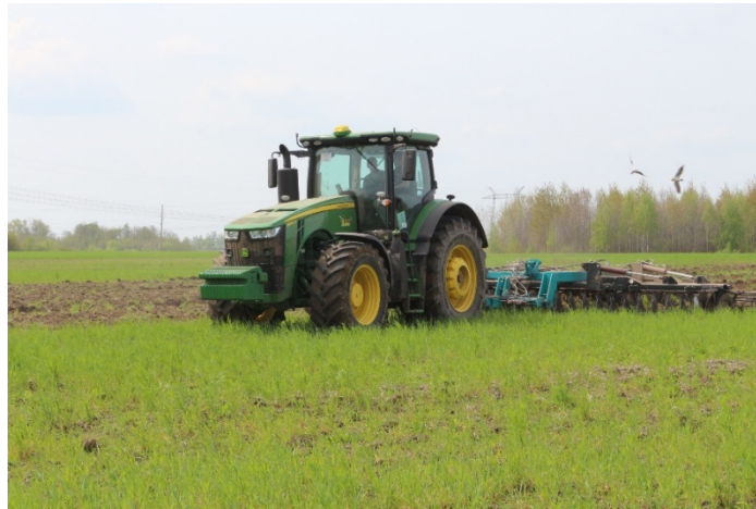
Рис. 2.3. Проведення експлуатаційних випробувань зміцнених і серійних робочих органів, встановлених на дисковій бороні БДВП-7,2.
