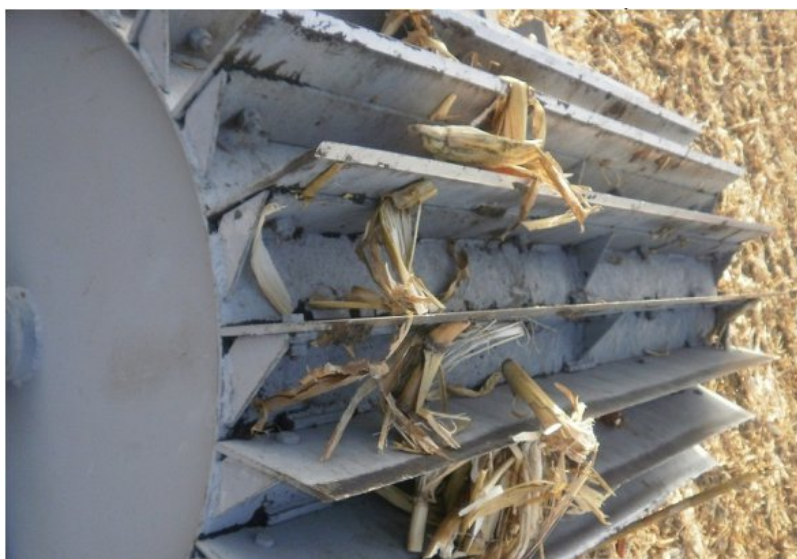
Рис. 1.2. Накопичення рослинних пожнивних решток кукурудзи між ножами барабана
