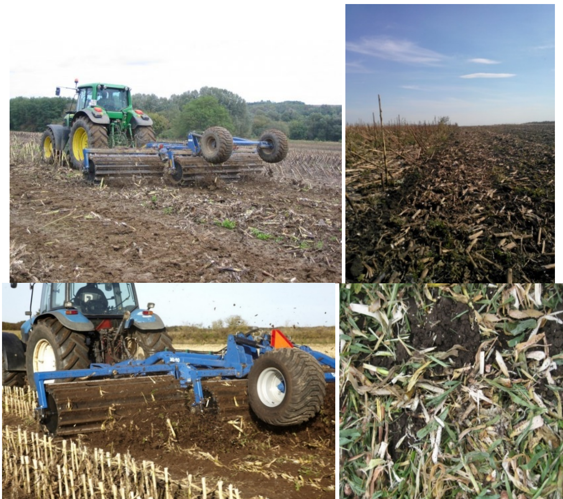
Рис. 3.7. Робота агрегату на різних агрофонах та вид поверхні після обробітку
