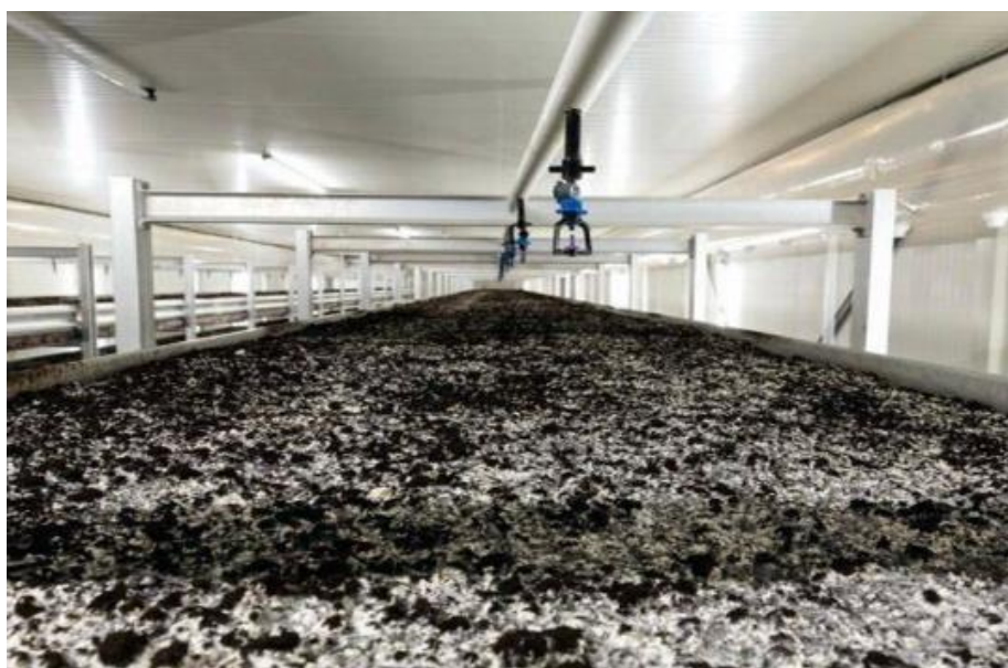
Рис. 1.4. Полив за допомогою трубопроводів [1].
