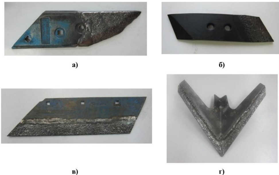
Рис. 3.17. Долото (а) і остов (в) лемеша оборотного плуга EuroDiamant 10 7+1 компанії Lemken, долото (б) оборотного плуга RN-100 компанії Kverneland, стрілчаста лапа (г) культиватора КШУ-12Н, відновлені з подальшим зміцненням способом КВДЗ за розробленим маршрутом
