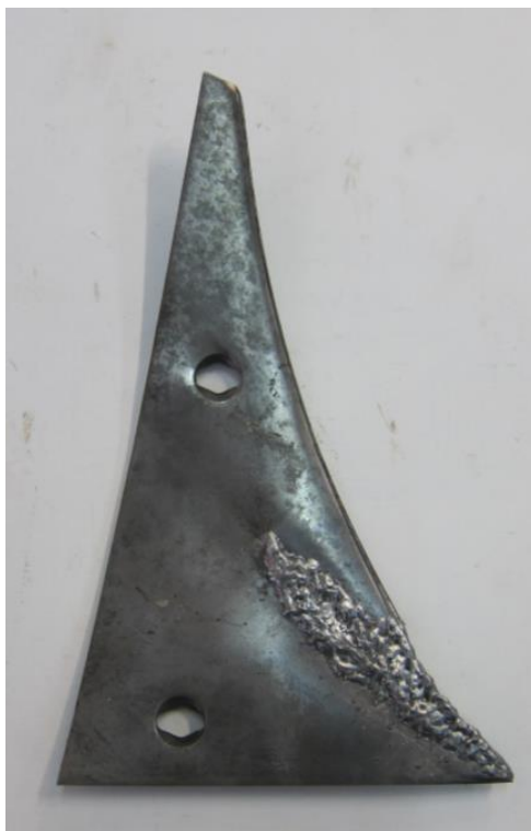
Рис.3.18. Грудь відвалу оборотного плуга компанії Kuhn після заплавлення променеподібного зносу.
