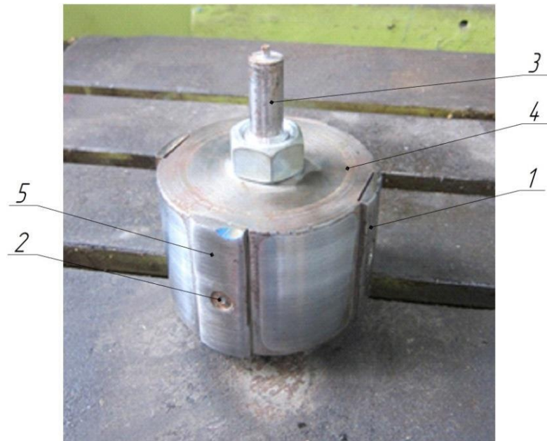
Рис. 2.3. Пристрій для проведення випробувань на зношування: 1 – зразок з покриттям; 2 – кріпильний гвинт; 3 – державка; 4 – оправка; 5 – еталонний зразок.
