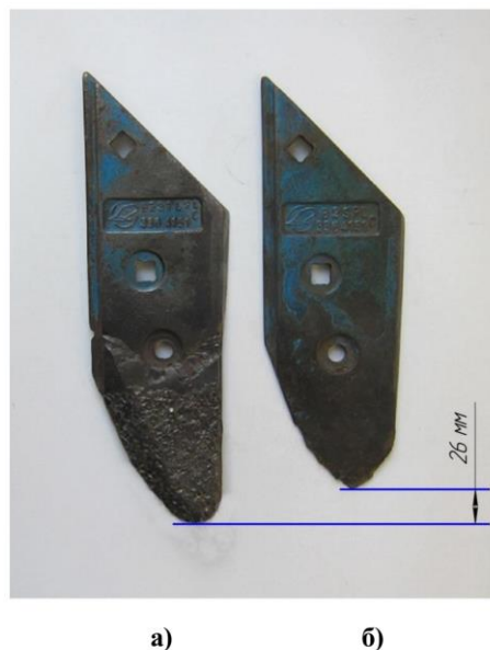
Рис. 3.7. Долоти оборотного плуга EuroDiamant10 7+1: відновлене з подальшим зміцненням КВДЗ (а) після напрацювання 32 га; заводського виконання (б) після аналогічного напрацювання (досягло граничного стану)
