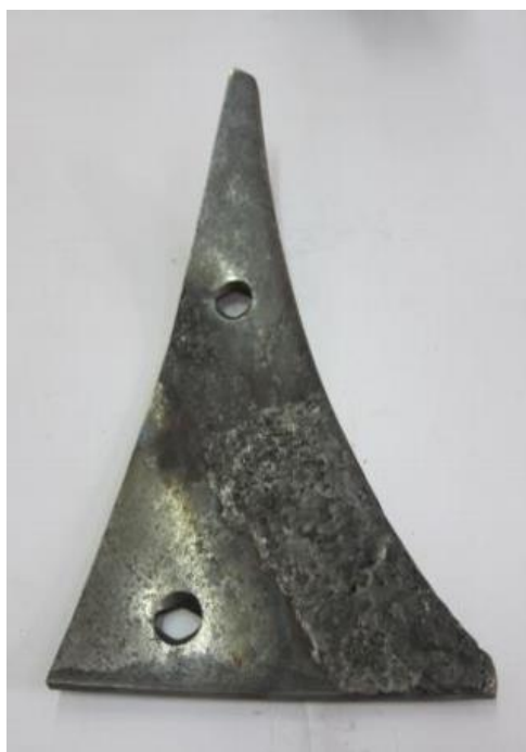
Рис. 3.19. Грудь відвалу оборотного плуга компанії Kuhn, відновлені з подальшим зміцненням способом КВДЗ за розробленим маршрутом
