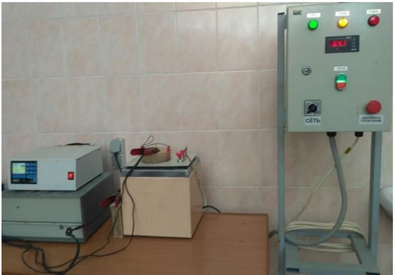
Рис. 2.6. Обладнання для нанесення нанокomпозиційних електролітичних покриттів
