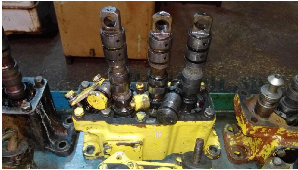
Рис. 2.12. Гідророзподільники Р160 3/1-222, відновлені за запропонованою технологією з використанням НКЕП на основі заліза
