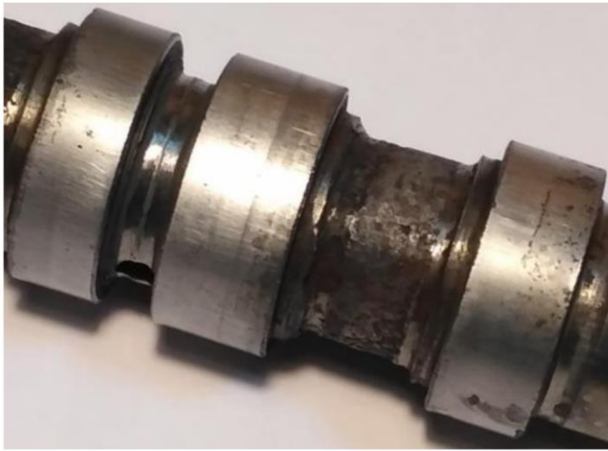
Рис. 1.2. Зношена поверхня робочих пояскових золотника гідророзподільника Р160
