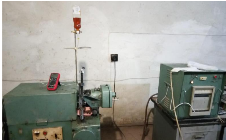
Рис. 2.6. Машина тертя СМЦ-2М для випробування хромових покриттів на знос
