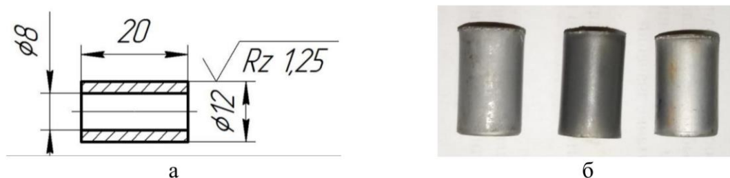
Рис. 2.1. Зразок-втулка: а – креслення, б – хромовані зразки
