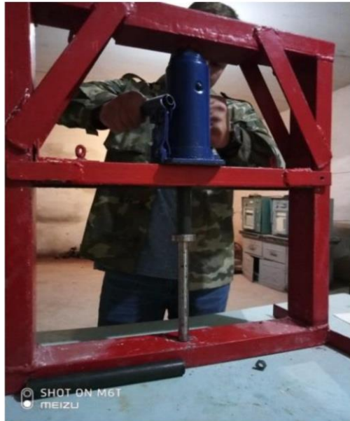
Рис. 2.4. Прес на 10 тс з оправкою для випробувань на міцність зчеплення
