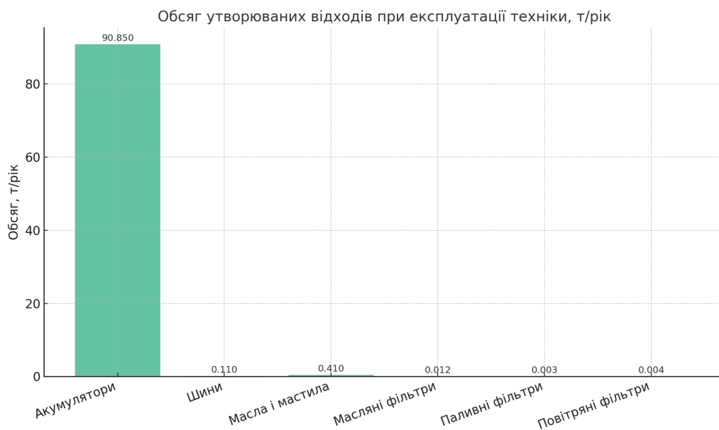
Рис. 6. Річні обсяги утворення відходів під час експлуатації кар'єрної техніки.
