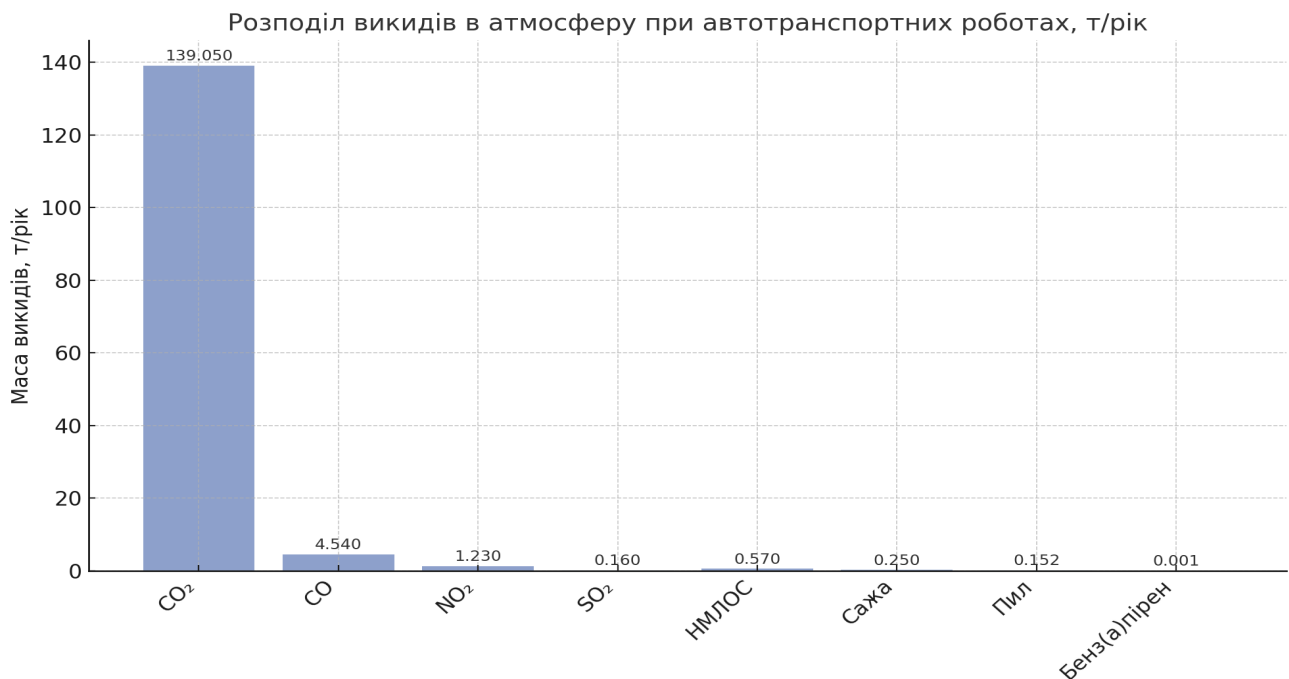
Рис. 10. Розподіл викидів в атмосферу при автотранспортних роботах
