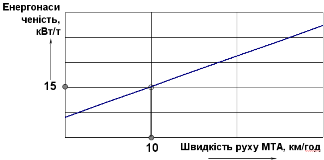
Рис. 3.1. Графічна залежність питомої потужності та швидкості руху МТА
