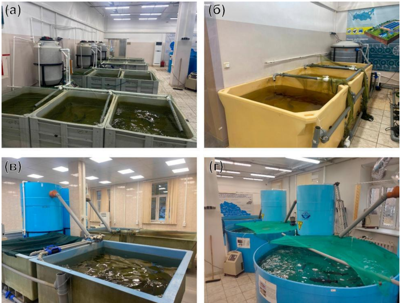
Рис. 2.15. Інфраструктурний ресурс для проведення експериментів: (а, б) – баки для проведення експериментальних робіт, лінія 4+1 з баками об'ємом 750 літрів (усього 12 баків); (в, г) – ємності для утримання риб об'ємом 3000 л [1].
