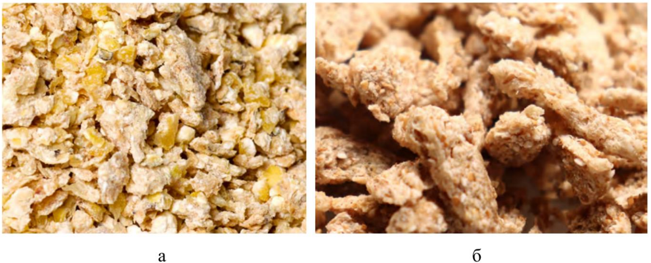
Рис. 1.11. Експандований продукт, отриманий на стандартному експандері Amandus Kahl (а) та на установці з подовжувачем робочої камери у вигляді корони (б) [5]
