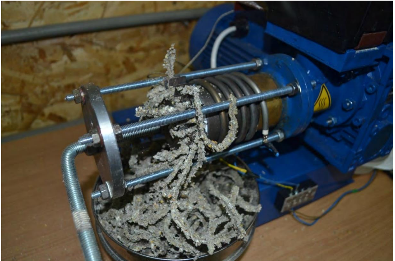
Рис. 2.14. Процес переробки контрольної наважки кормосуміші.
