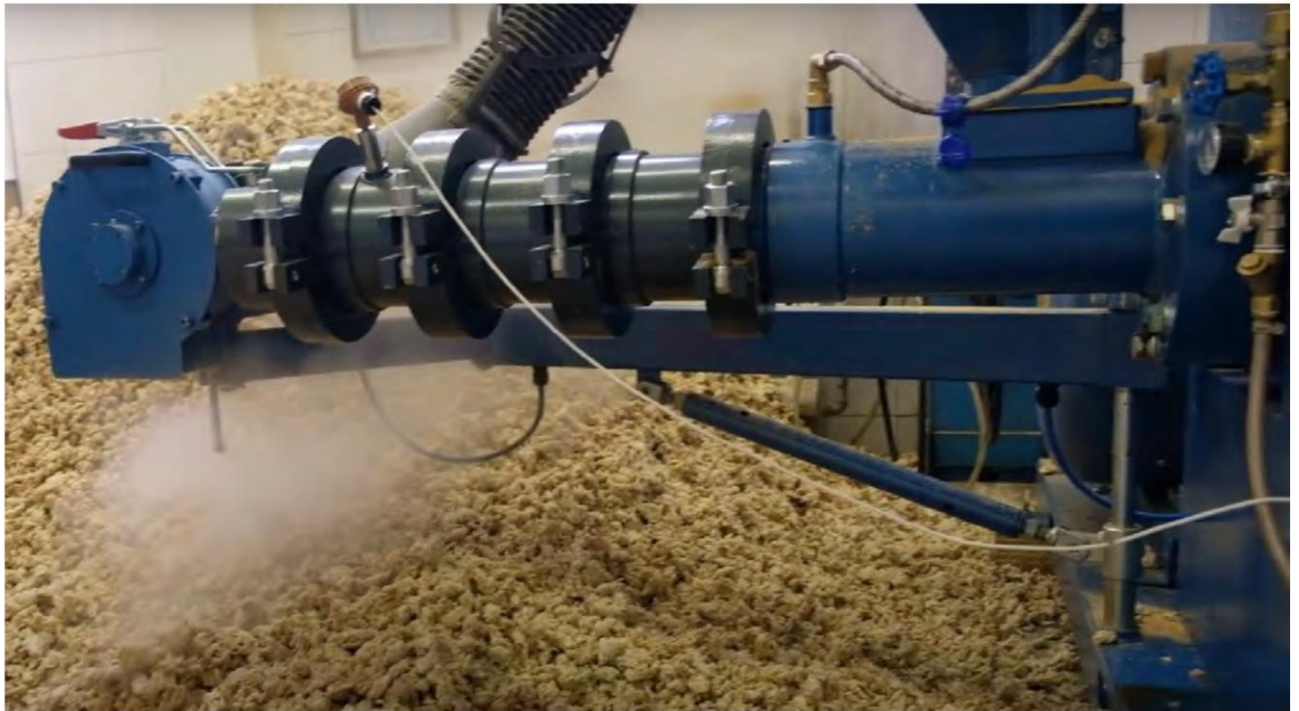
Рис. 3.5. Загальний вигляд експандера для виробництва кормів
