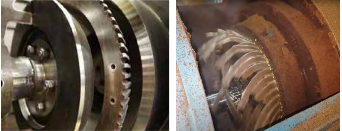
Рис. 1.8. Запирний конус експандера серії Solvex компанії Anderson Feed Technology.
