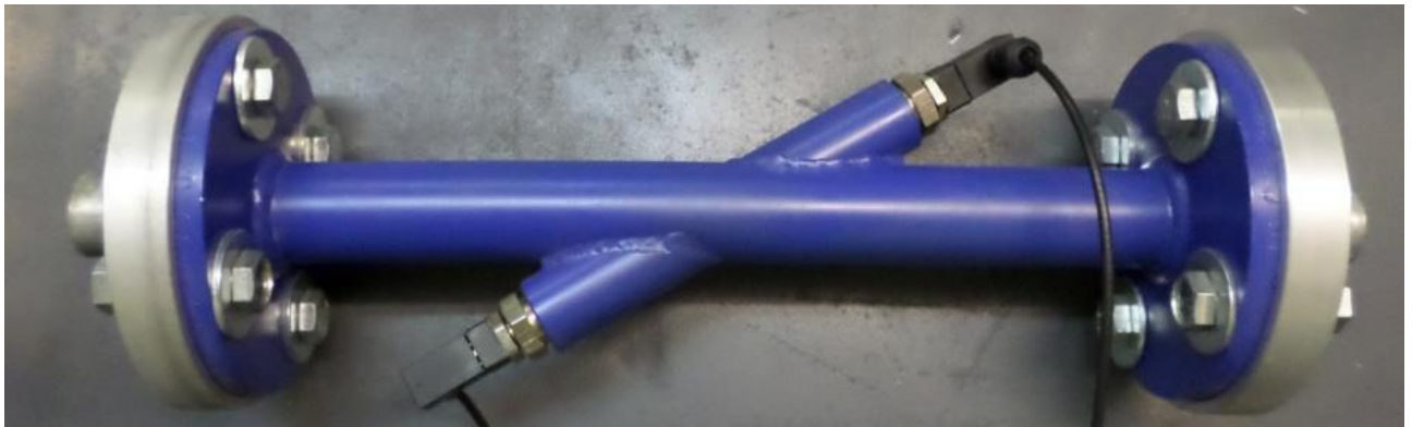
Рис. 3.2. Ультразвуковий витратомір US-800.
