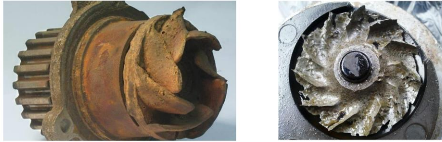
Рис. 1.9. Кавітаційна ерозія та забруднення лопатей крильчатки рідинного насоса двигуна [2]
