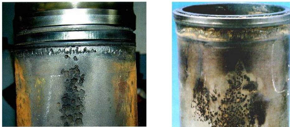
Рис. 1.8. Кавітаційна ерозія гільзи двигуна [1].
