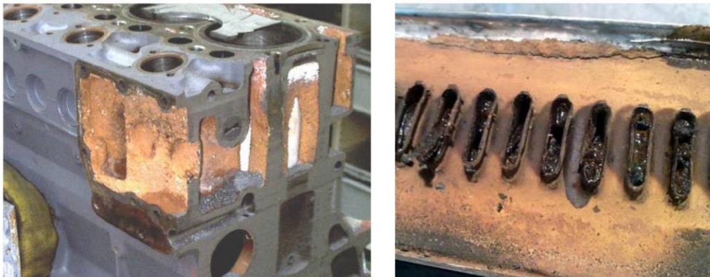
Рис. 1.10. Корозійний шар на внутрішній поверхні блока двигуна та у внутрішній порожнині радіатора із засміченням каналів [2].
