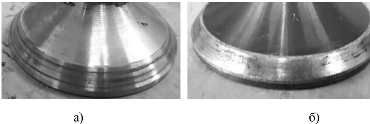
Рис. 3.6. Клапани після випробувань: а) клапан зі стандартним покриттям; б) клапан з зміцнюючим покриттям.
