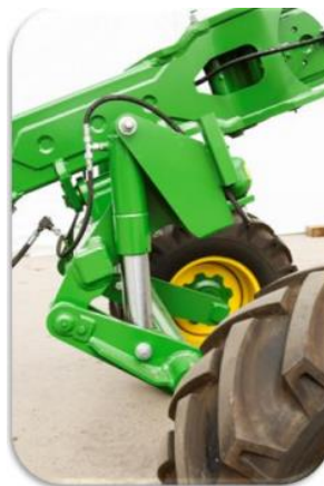
Рис. 1.10. Гнучка рама у поєднанні з центрально розташованим візком
