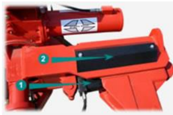
Рис. 2.10. Напівначіпний плуг – регулювання першого корпусу 1 – гвинт регулювання першого корпусу; 2 – кришка.
