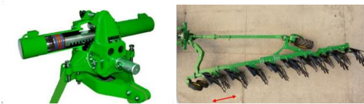
Рис. 1.14. Зубчасто-рейковий механізм обороту бруса корпусів плуга
