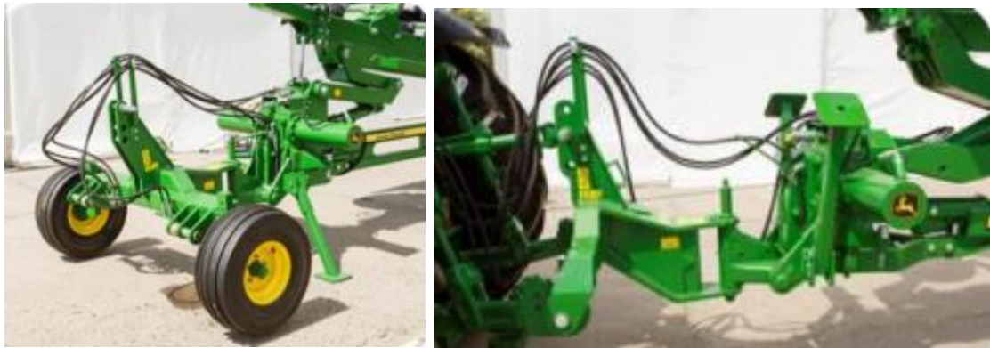
Рис. 1.13. Причіпний підйомник ( а ) та конверсійний комплект для сумісності ( б )
