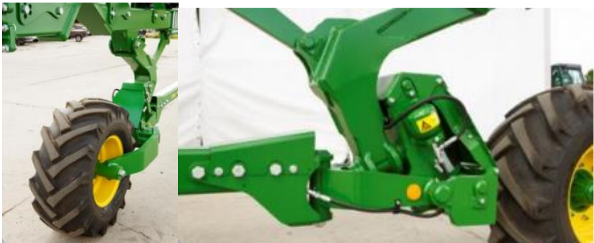
Рис. 1.5. Транспортно-опорне колесо плуга оснащено гідроциліндром з азотним акумулятором
