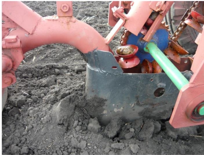
Рис. 3.11. Технологічний процес скидання бульб ложечками транспортера на дно борозни.
