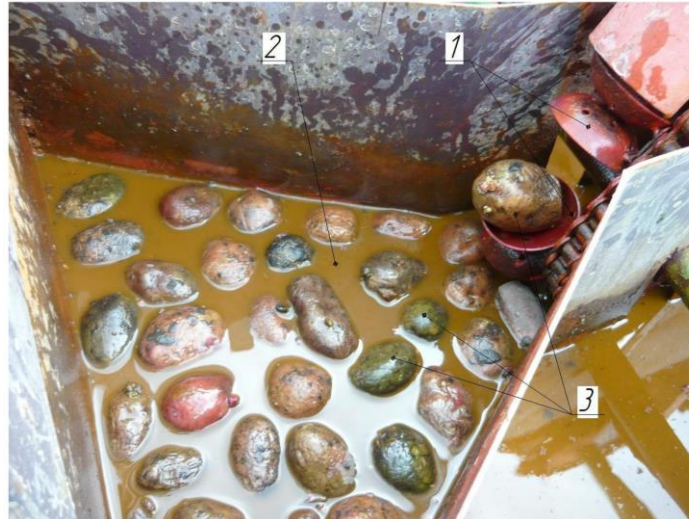
Рис. 3.9. Технологічний процес захоплення бульб ложечками транспортера в ковші-живильнику: 1 – ложечки транспортера; 2 – водно-сольовий розчин протравлюючої рідини; 3 – пророщені бульби картоплі (бульби картоплі в 1 шар).
