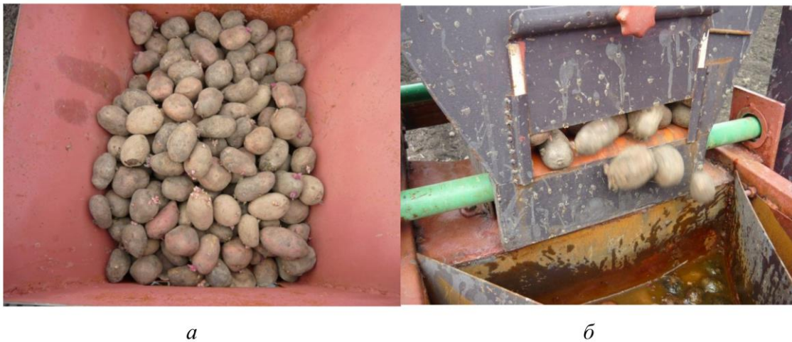
Рис. 3.12. Бункер насіннєвих бульб: а – бункер у завантаженому стані; б – вивантажне вікно в відрегульованому стані.
