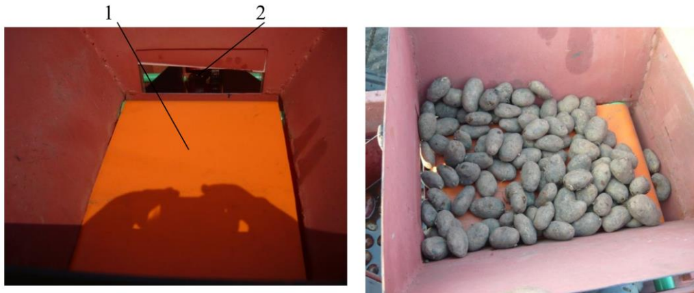
Рис. 3.3. Бункер насінневих бульб: 1 – донний стрічковий транспортер; 2 – вікно приймальне.
