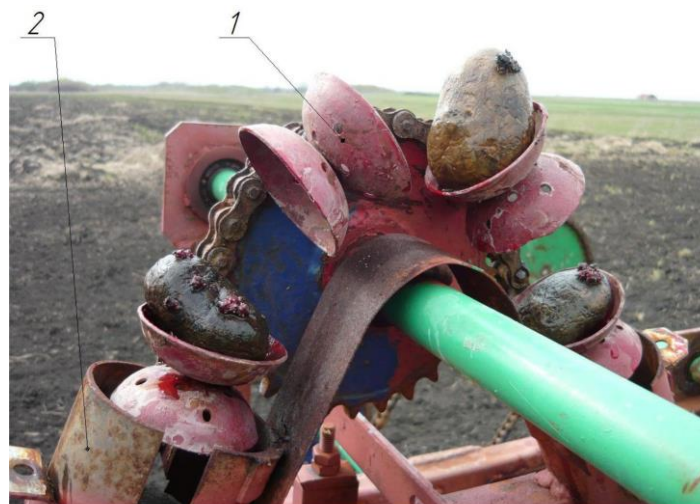
Рис. 3.10. Технологічний перехід бульби з ложечки, що захопила бульбу, на тильну сторону другої ложечки: 1 – ложечка транспортера; 2 – захисний кожух.
