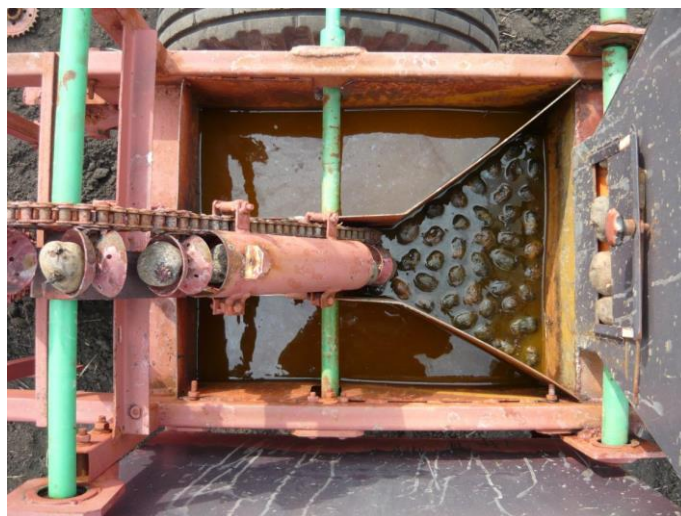
Рис. 3.13. Технологічний процес захоплення бульб ложечками транспортера в ковші-живильнику (бульби картоплі в 2 шари)
