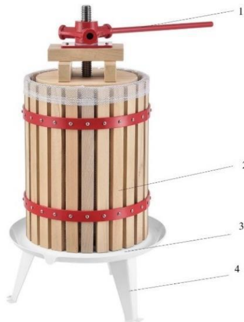
Рис. 1.6. Гвинтовий прес П-10: 1 – важіль; 2 – корпус преса; 3 – ємність для збирання соку зі стікателем; 4 – станина преса.
