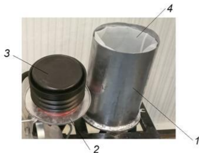
Рис. 2.5. Фрагмент мембранно-вакуумного преса: 1 – корпус преса; 2 – кришка; 3 – гофрована мембрана; 4 – перфорована вставка з лавсановим мішком.
