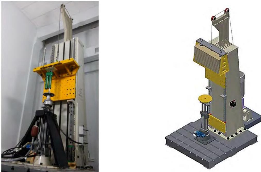
Рис. 3.1. Сервогідравлічний стенд для проведення випробувань.
