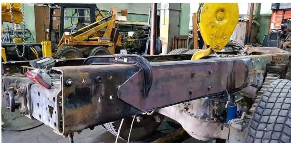
Рис. 1.1. Монтаж бокового підсилювача рами
