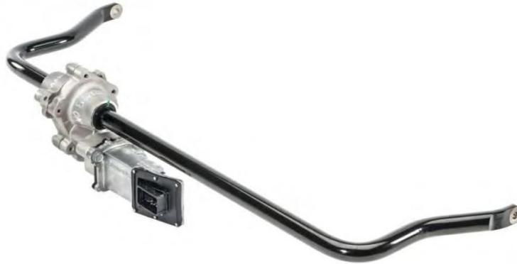
Рис. 1.4. Регульований стабілізатор поперечної стійкості [2].
