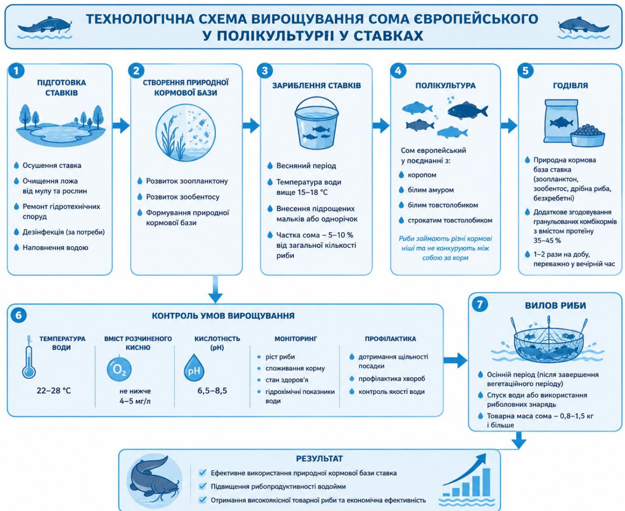
Рис. 6. Технологічна схема вирощування сома європейського у ставках у полікультурі в умовах СТОВ «Прогрес»
