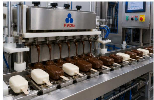
Рис. 3.4. Процес глазурування морозива шоколадною глазур'ю
