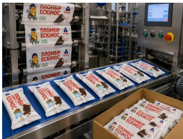
Рис. 3.5. Пакування готового морозива «Ескімос»
