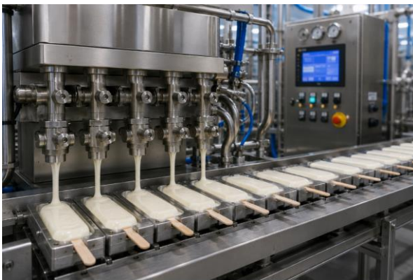
Рис. 3.3. Процес фризерування морозива «Ескімос»
