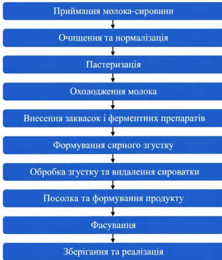
Рис. 3.7. Схема сучасної технології виробництва сирних молоковісних продуктів ТМ «Cheese Life»
