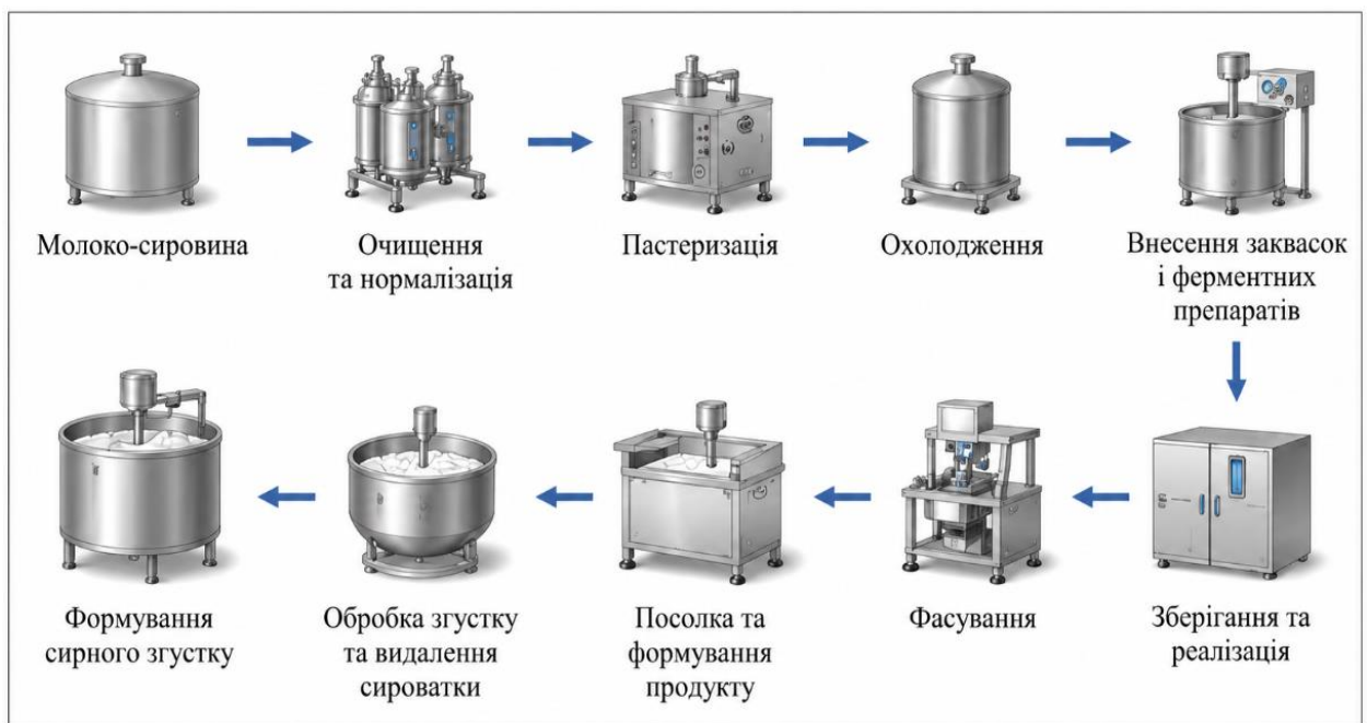
Рис. 3.6. Технологічна схема виробництва сирних молоковісних продуктів ТМ «Cheese Life»
