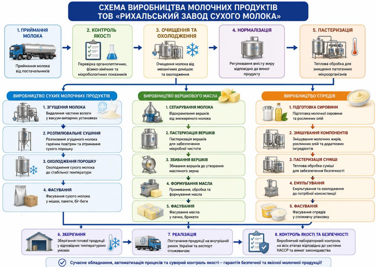
Рис. 5. Загальна технологія виробництва молочної продукції в умовах ТОВ «Рихальський завод сухого молока»
