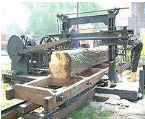
Рис. 2.1. Лісопилльні рами: а – горизонтальні; б – вертикальні.
