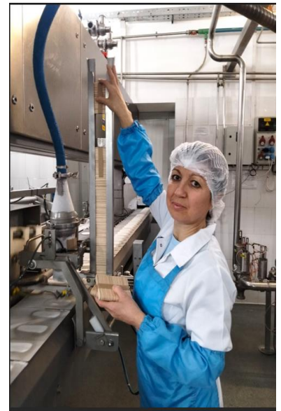
Рис. 3.30. Процес фасування та формування порцій морозива
