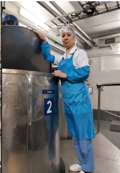
Рис. 3.29. Дозрівання морозивної суміші перед процесом фризерування
