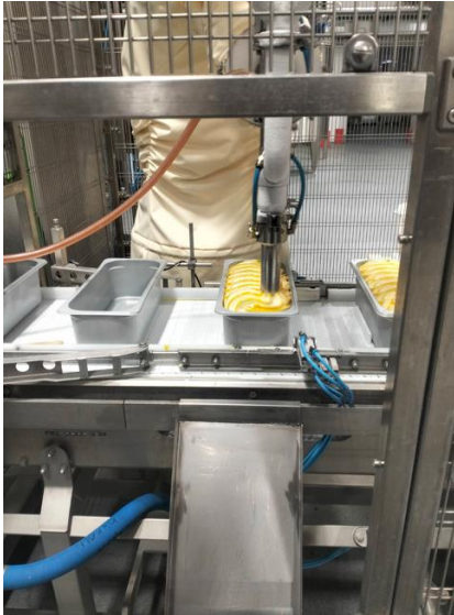
Рис. 3.34. Процес автоматизованого дозування та фасування морозива у споживчу тару
