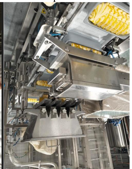
Рис. 3.33. Автоматизована лінія фасування та формування морозива НоReCa-лінійки АТ «Рудь»
