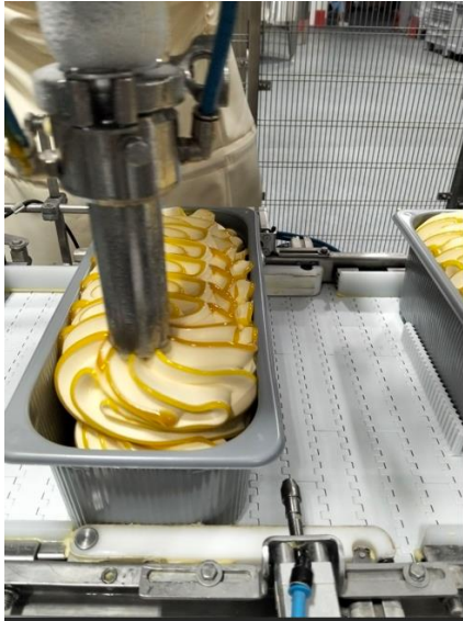
Рис. 3.35. Формування структури та декоративного шару морозива під час фасування продукції
