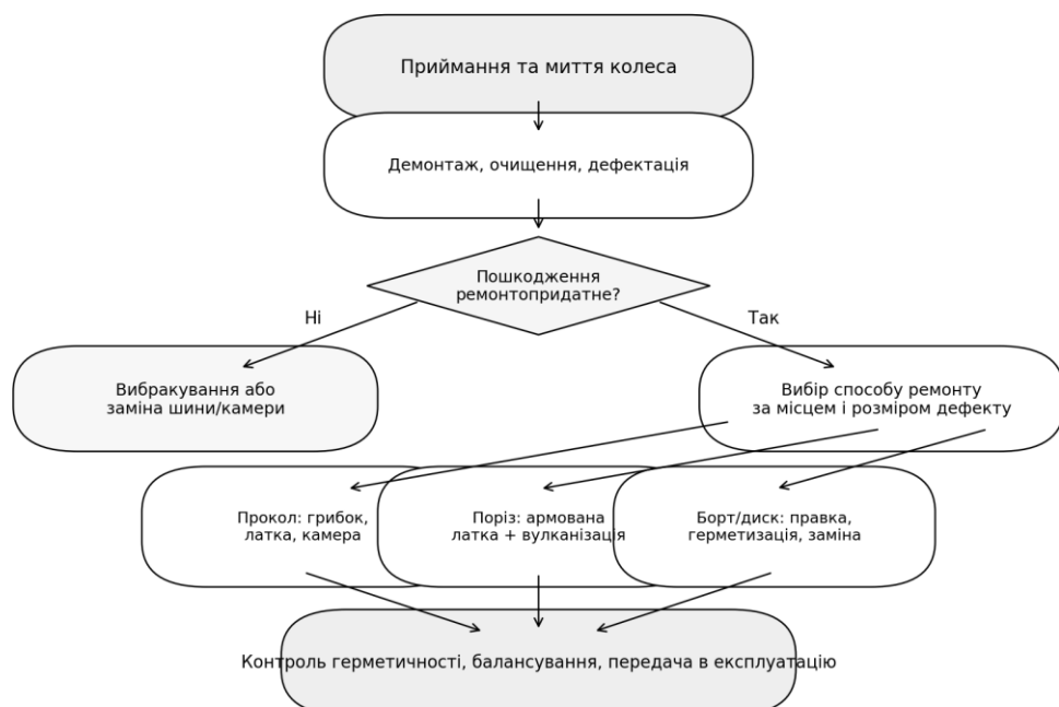
Рис. 2.4. Алгоритм вибору технології ремонту шини.
