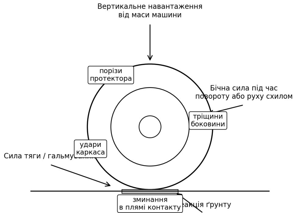
Рис. 2.2. Схема дії основних експлуатаційних навантажень на колесо.
