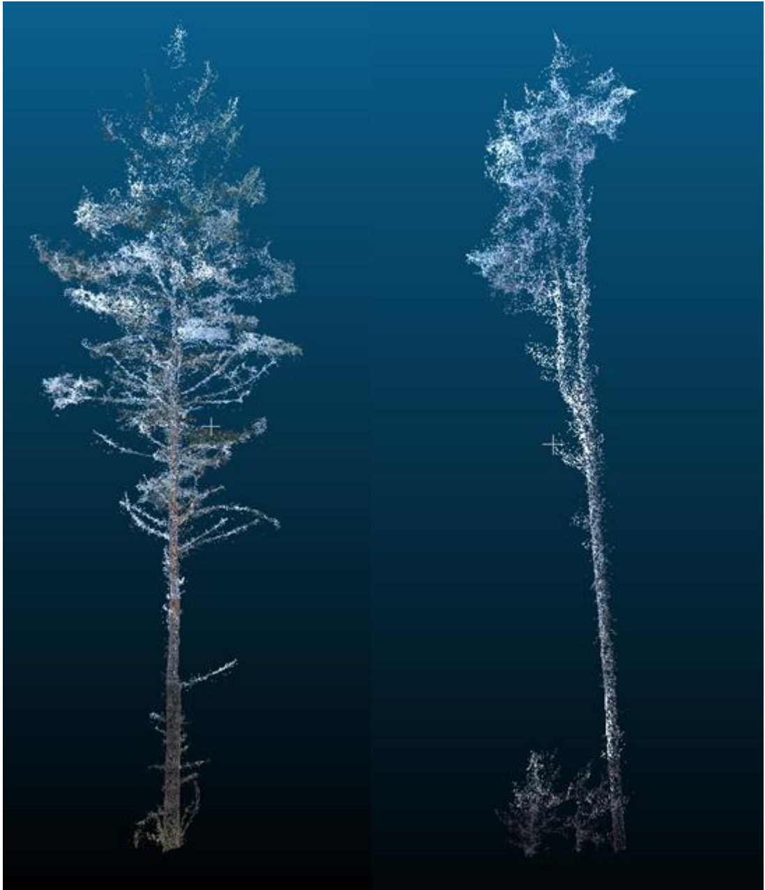
Рис.3.10.. Приклади хмар точок окремих дерев з діаметром стовбура від 0,45 м (згідно обчислень програми), виділених в цілому коректно (ліворуч) та з явними помилками (праворуч).
