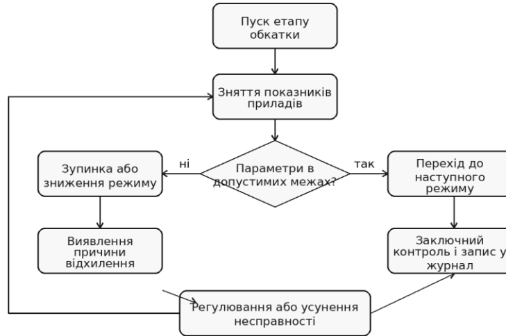
Алгоритм контролю якості під час обкатки ДВЗ
