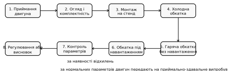
Схема технологічного процесу обкатки відремонтованого ДВЗ
