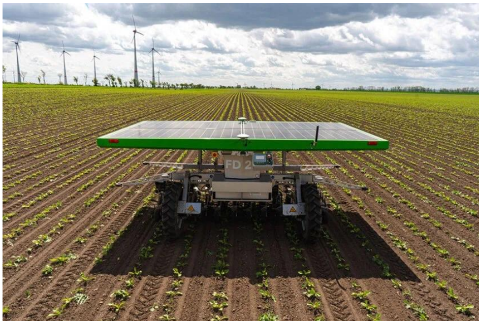
Рис. 2.2. Автономний робот FarmDroid FD20 для механічного прополювання міжрядь.
