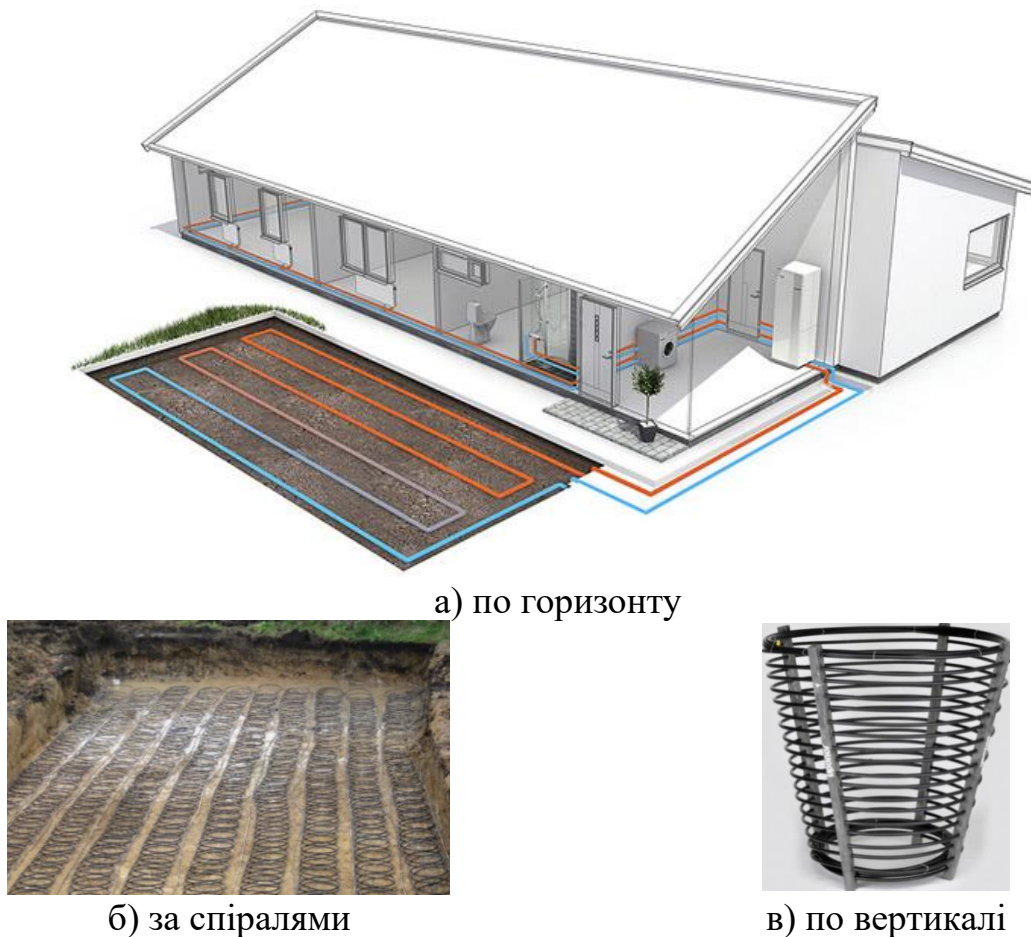
Рис. 1.3. Загальний вигляд «ґрунтового» теплового насоса із різними схемами забору тепла ґрунту.
