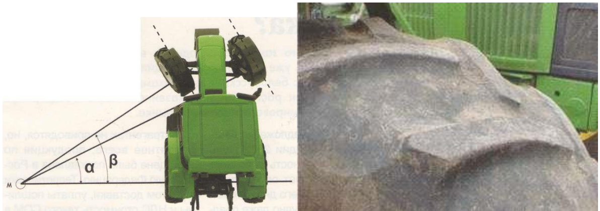
Рис. 2.7. Відсутність паралельності повороту.
